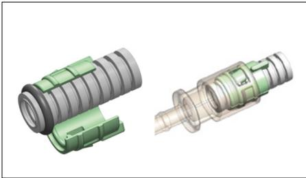
4. Nach der Montage ist die Verbindung auf Dichtheit zu überprüfen! Sollte die Verbindung undicht sein, wurde ein falscher Dichtring gewählt. In diesem Fall ist ein anderer Dichtring zu wählen und die Verbindung erneut auf Dichtheit zu prüfen. Die Verbindung kann durch eine 45°-Drehung ohne Werkzeug wieder gelöst werden.
