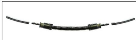
3. Du tube ondulé est utilisé dans le véhicule et un morceau défectueux de ce tube doit être réparé en utilisant du tube ondulé. La réparation, réalisée au moyen du raccord, de la bague d'étanchéité, des clips et du tube ondulé inclus dans le kit de réparation, est expliquée en détail au chapitre « Utilisation ».
